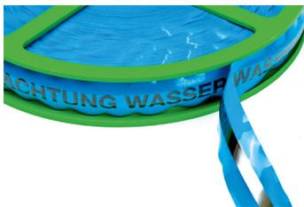
Das **KELMAPLAST-Ortungsband Nr. 04** aus PE verfügt über ein an der Unterseite aufgebrachtes, 100 mm breites und 0,1 mm dickes, korrosionsfreies Edelstahlband, dessen fortlaufender Bodenkontakt eine einwandfreie Erdung garantiert.
