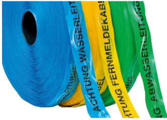
In das **KELMAPLAST-Ortungsband Nr. 06** sind zwei korrosionsfreie Edelstahldrähte mit jeweils 0,5 mm Durchmesser sinusförmig zwischen zwei Folien einkaschiert. Eine fortlaufende Aussparung der transparenten Folie sorgt für ausreichende Erdfähigkeit zur Erzeugung des für die Ortung nötigen Magnetfelds.
